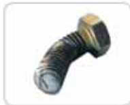
강한 외력과 진동에 의한 볼트 파괴 형상
